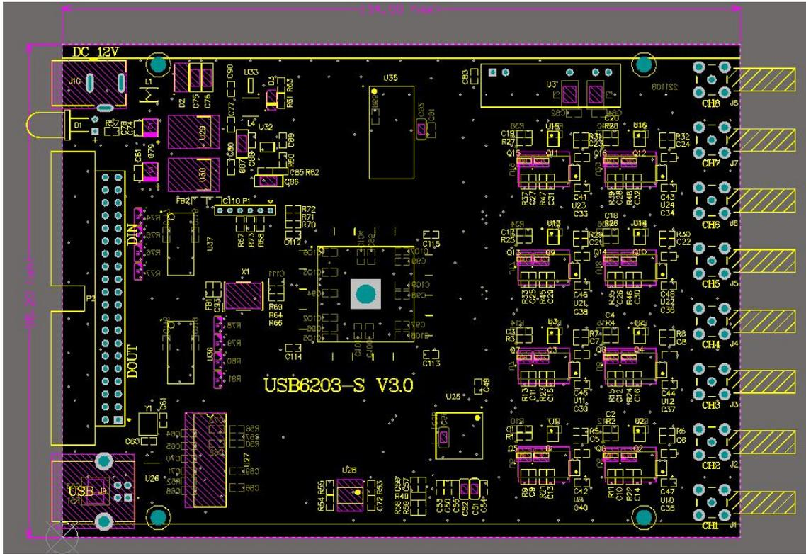
CH1-CH8 对应为 8 路模拟量输入接口。DIN 为 16 路数字输入；DOUT 为 16 个数字输出口。
